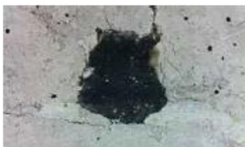
Primer plano de una sección transversal de hormigón que muestra las propiedades de hinchamiento del sello para agua PENEBAR SW.
